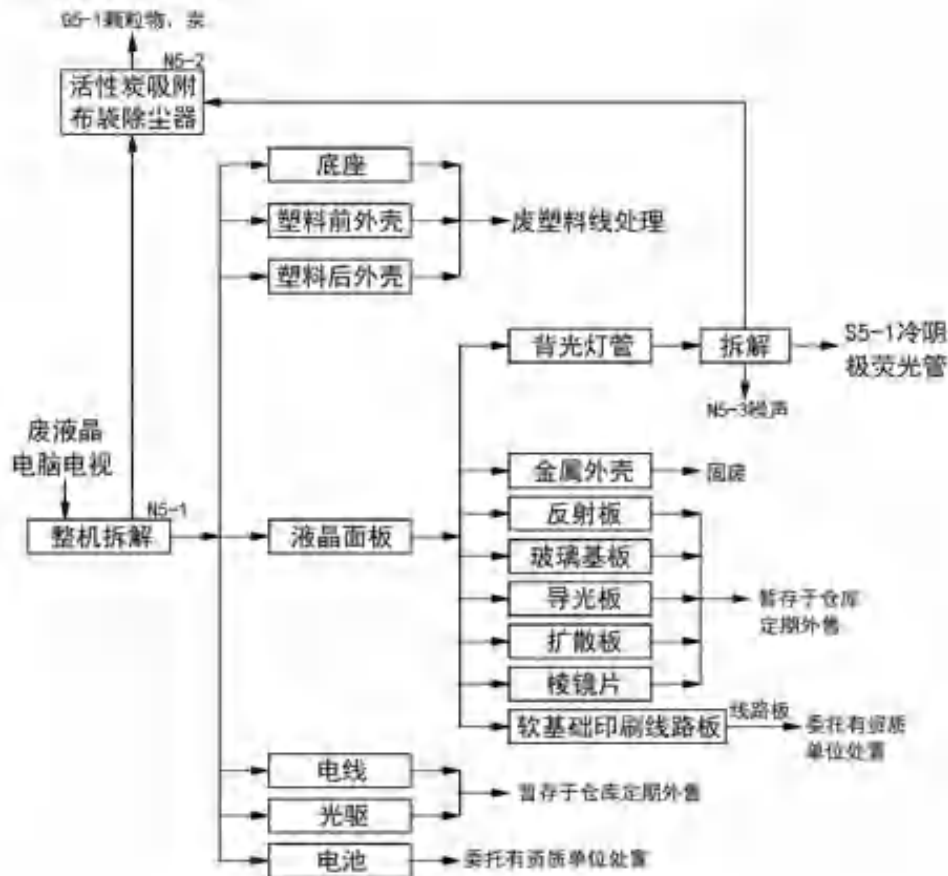
2.1-3 废液晶电视电脑拆解工艺流程图
