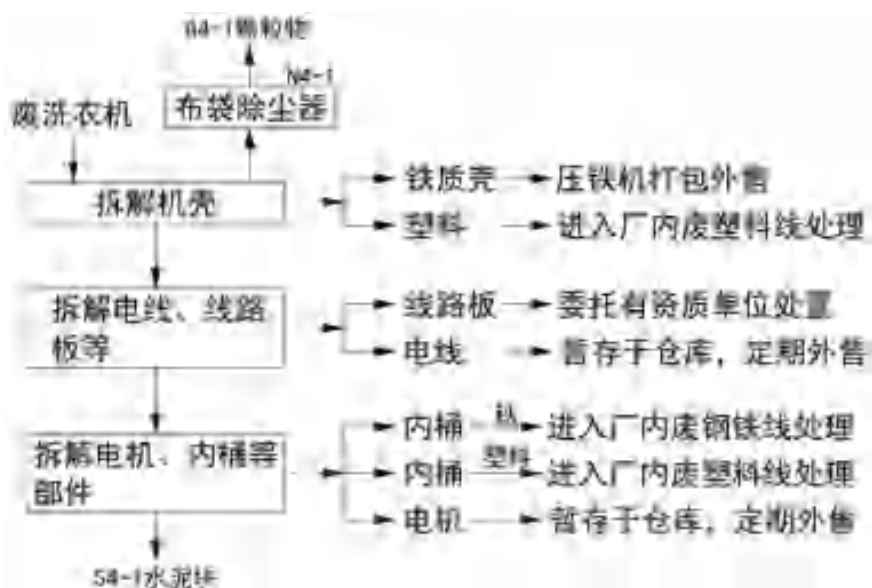
图 2.4-2 废洗衣机拆解工艺流程图
