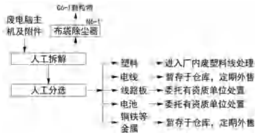
2.1-4 废电脑主机及配件拆解工艺流程图
