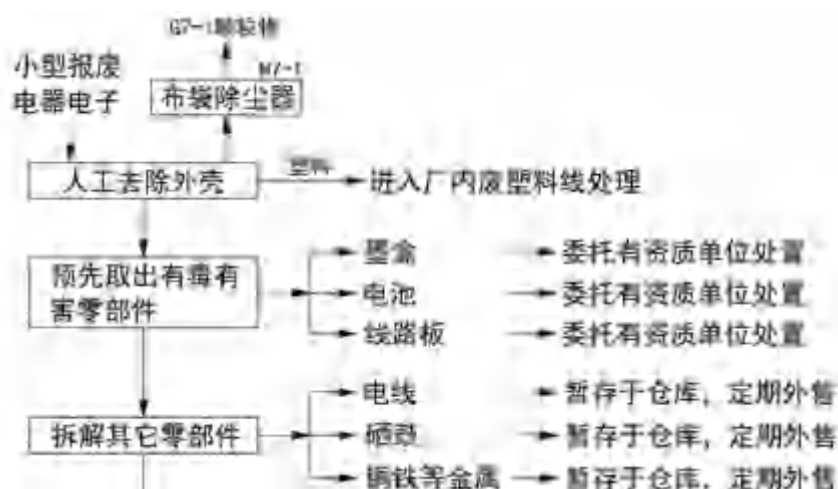
图 2.4-3 小型报废电器电子拆解工艺流程图
